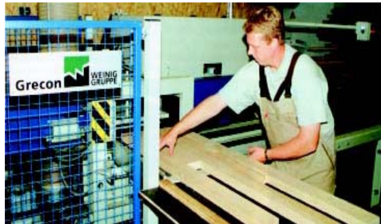
Unit pembentuk Finger Joint "ProfiJoint" dimasukkan papan kayu secara bersamaan
